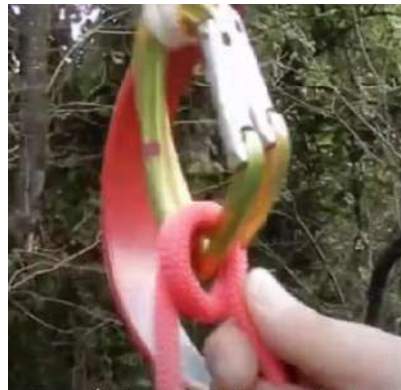
ガルダーによるオートブロック (ロープを1回半巻く)
