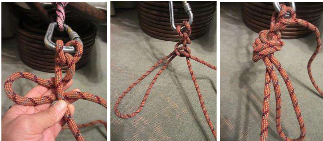
半マスト結びにミュールノット ループは30cm以上出す 末端処理を忘れずに
