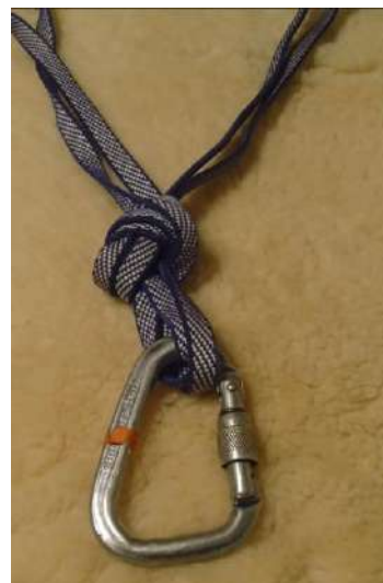
固定分散：クローブヒッチによる方法 オーバーハンドノットによる方法
