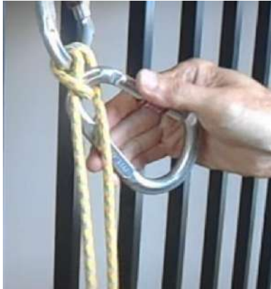
半マスト結びのオートブロック ロレンツィのオートブロック ビエンテによるオートブロック
