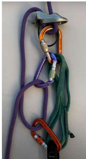
カラビナ2ケによる折り返し カラビナによる懸垂システム+ATC
