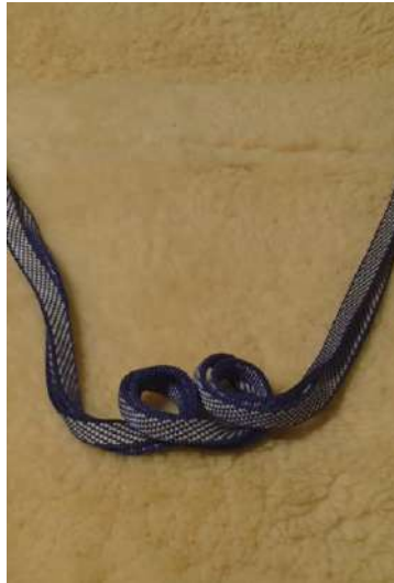
流動分散：片方だけ輪を作り、両方のスリングにカラビナをかける
