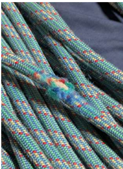
損傷したトップロープ支点構築用のロープ
