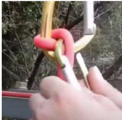
半マスト結びのオートブロック ロレンツィのオートブロック ビエンテによるオートブロック
