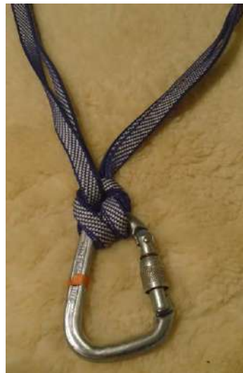
固定分散：クローブヒッチによる方法 オーバーハンドノットによる方法
